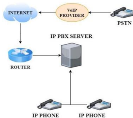
Gambar 2. Cara Kerja IP PBX pada jaringan WAN
