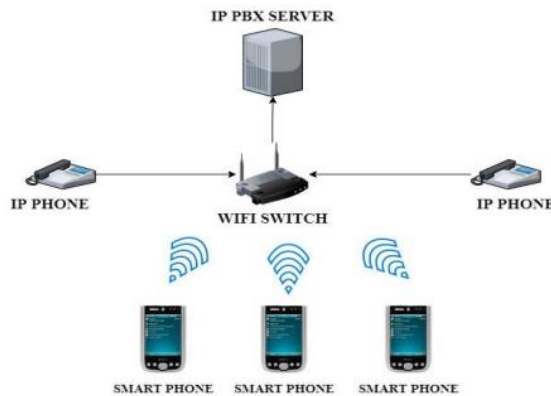
Gambar 3. Cara Kerja IP PBX pada jaringan Local
